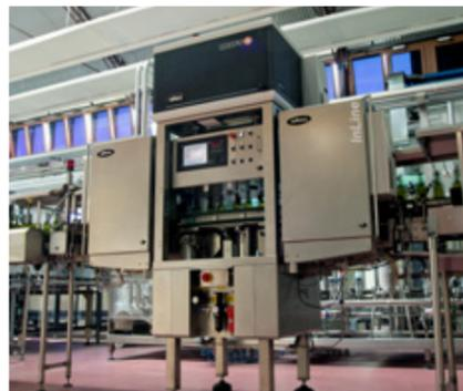
Die zusätzlich integrierbare Seitenwandinspektion realisiert eine lückenlose Überprüfung von Leerflaschen.
