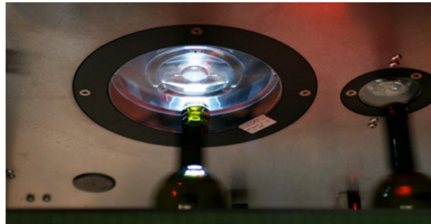
schen ebenfalls servogesteuert justiert. Mit bloßem Auge kaum zu erkennende transparente Glassplitter sowie Muschelbrüche und Abplatzer am Behälterboden identifiziert der HEUFT InLine IXS. Dazu ist er nicht nur mit bewährten optischen Erkennungseinheiten und Servoantrieben zur gezielten Behälterdrehung ausgestattet, sondern auch mit der einzigartigen, besonders schonenden und präzisen
