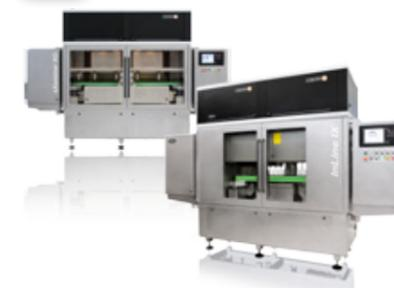
Seine nie dagewesene Erkennungssicherheit verdankt der Leerflascheninspektor HEUFT InLine IX der selbst entwickelten Röntgentechnologie, die bislang nur in Vollgutinspektoren der HEUFT eXaminer-Reihe zum Einsatz kam. Im Gegensatz zu herkömmlichen Röntgengeräten wird dabei nur in dem Moment Strahlung emittiert, in dem sich tatsächlich eine zu untersuchende Flasche im Inspektionsbereich befindet – und das in Form eines jeweils nur eine Tausendstelsekunde andauernden Röntgenblitzes. Diese extrem
