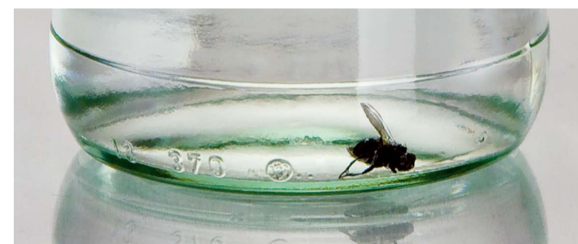
Ein perfektioniertes Inspektionsverfahren minimiert das Risiko, dass Fremdkörper geringer Dichte wie dieses Insekt am Flaschenboden übersehen werden.
