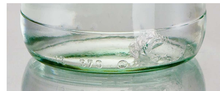
Zu den Fehlern, die jetzt selbst auf schwer inspizierbaren Bodenpartien detektiert werden können, zählen auch transparente Folien.
